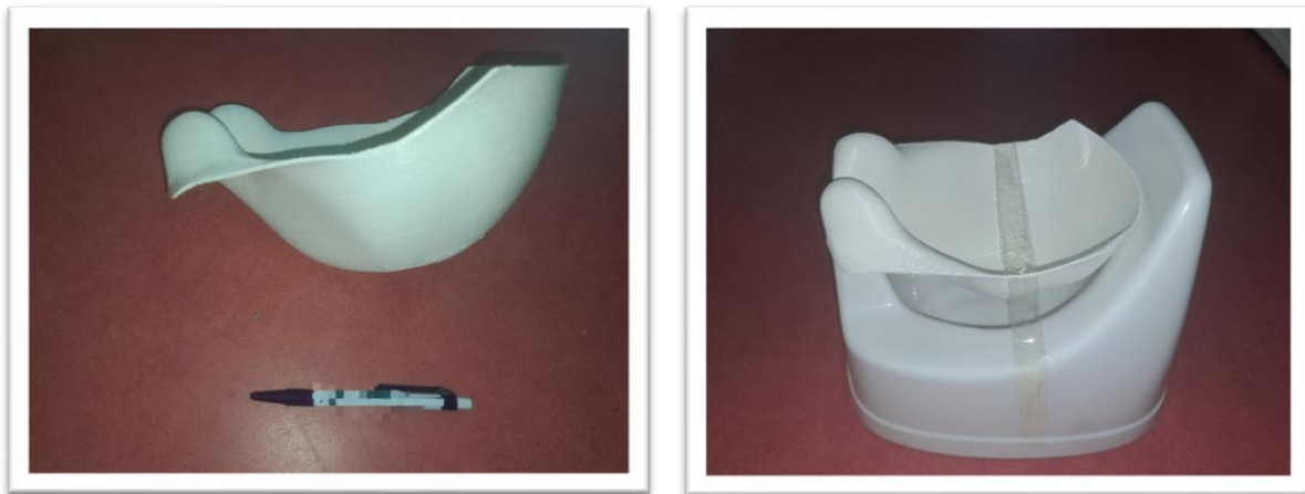
Figura 1 y 2. Molde 3D del depósito del “Pipicount” .
